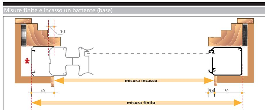
\*Nell'installazione ad incasso dell'un battente si può omettere l'utilizzo del profilo a "U" coprendo il foro in altezza.
